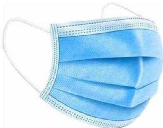
Mascarilla descartable de tres pliegues, de diseño anatómico, ultra liviano y ergonómico para protección contra partículas del ambiente y aerosoles. Posee sujetador de elástico y clip nasal, fabricado a base de tela no tejida de polipropileno, con láminas filtrantes con microfibras de polipropileno.
