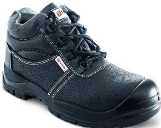
Calzado de seguridad perteneciente a la línea standard fabricado por sistema de inyectado de PU, para menor peso y mayor fortabilidad. Capellada de cuero vacuno estampado y suela de PU/TPU antideslizante y resistente a hidrocarburos. Puntera con refuerzo de PU. Incorpora plantilla antiperforante de acero.
