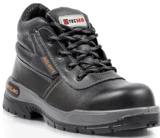
Calzado de seguridad perteneciente a la línea standard fabricado por sistema de inyectado de PU, para menor peso y mayor fortabilidad. Capellada de cuero vacuno suela de PU mono densidad antideslizante y resistente a hidrocarburos. Incorpora plantilla anti perforante aramida (kevlar)
