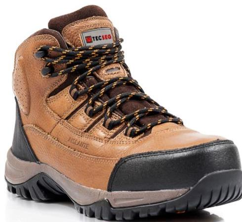
Calzado de seguridad perteneciente a la línea PREMIUM TECSEG. Fabricado bajo el sistema cementado, capellada 100% cuero hidrofugado, suela de caucho nitrilo antideslizante, dieléctrica y resistente a hidrocarburos. Incorpora plantilla antiperforante Kevlar y membrana impermeable respirable.
